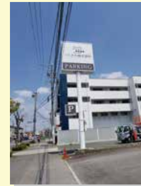
ポールサイン 枠 / 鉄枠 表示面 FF シート 文字 / カッティング
