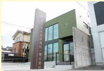
シンボルサイン 枠 / 鉄骨 + 鋼板 文字アクリル LED 内照式
