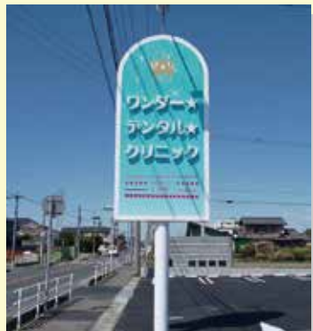
シンボルサイン 表示面アルミ複合板 + インクジェット 文字 / アクリルチャンネル LED 投光器
